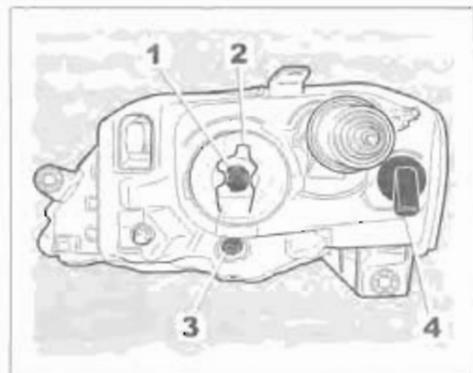
Отсоедините разъем от лампы **1**. Отсоедините пружинный фиксатор **2** и извлеките лампу.
