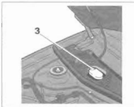
**Заправка:** откройте пробку **3**, залейте жидкость до видимого уровня и закройте пробку. Этот бачок обеспечивает жидкостью омыватели ветрового и заднего стекол.
