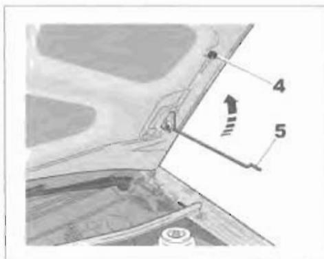
Прежде чем закрыть капот, убедитесь, что Вы ничего не забыли в моторном отсеке. Чтобы закрыть капот, возьмитесь за середину передней кромки капота, приподнимите его, установите упор **5** в фиксатор **4** и опустите его примерно до высоты 20 см от закрытого положения, затем отпустите. Капот закроется под собственной тяжестью. После выполнения работ в моторном отсеке следите за тем, чтобы ничего не забыть (ветошь, инструменты и т.п.).
