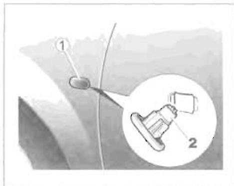
С помощью инструмента типа плоской отвертки отсоедините боковой повторитель указателей поворота **1**. Поверните патрон **2** на четверть оборота, чтобы извлечь лампу.
