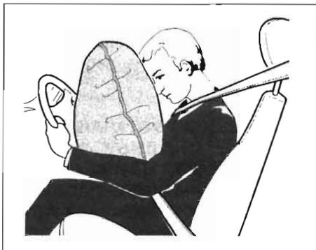
Эти подушки безопасности могут быть оборудованы места водителя и переднего пассажира. Надписи «Airbag» на рулевом колесе и на приборной панели, а также соответствующая наклейка на нижней части ветрового стекла или на солнцезащитном козырьке свидетельствуют о том, что данное оборудование установлено на автомобиле.
