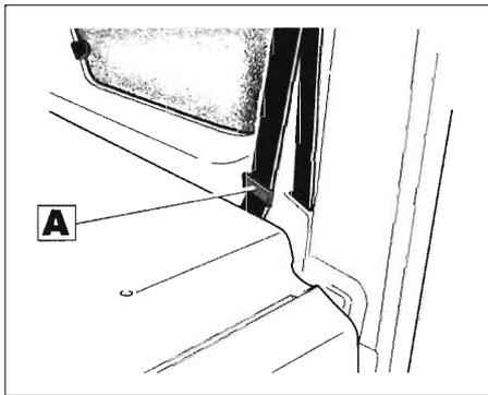
Когда ремень безопасности на заднем сиденье второго ряда не используется, он обязательно должен быть прикреплен к крючку **A**, чтобы не повредить ремень или полку багажного отделения (если она имеется на Вашем автомобиле).
