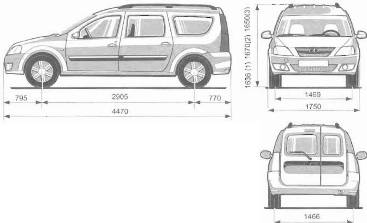
(1) Без рейлингов. (2) С рейлингами. (3) Автомобили комплектации «фургон».
