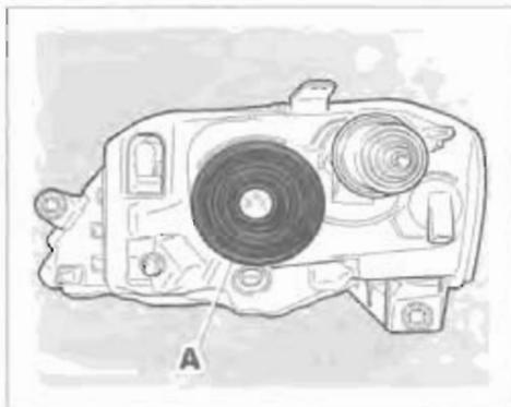
Снимите крышку и резиновый пыльник **A**.
