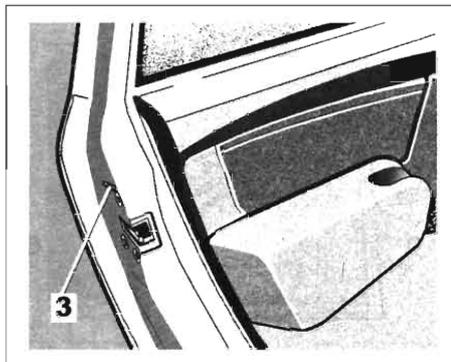
Чтобы сделать невозможным открытие задних боковых дверей автомобиля изнутри, переместите рычажок **3** на каждой двери, закройте двери и изнутри проверьте надежность их блокировки.
