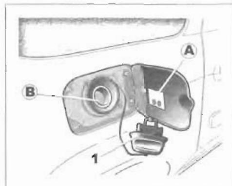
**Полезная емкость топливного бака 50 литров** (приблизительно).
