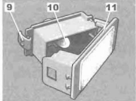
Нажмите на фиксатор **9**, чтобы отсоединить рассеиватель **11** и получить доступ к лампе **10**.
