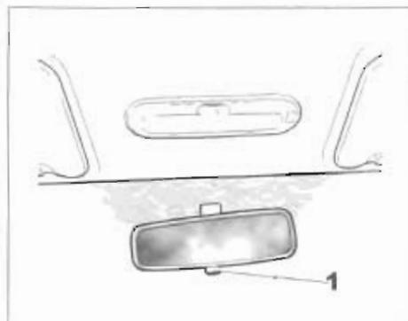
Положение зеркала регулируется. Во время движения в темное время суток во избежание ослепления светом фар идущего сзади автомобиля нажмите на рычажок **1**, расположенный в нижней части корпуса зеркала.
