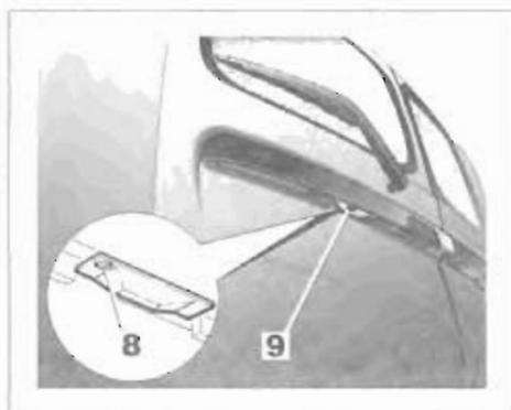
Отверните винт **8** с помощью инструмента типа плоской отвертки. Снимите крышку фонаря для доступа к лампе **9**.
