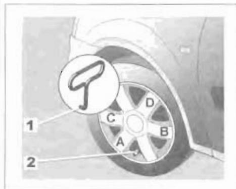
Снимите его с помощью ключа для снятия декоративного колпака **1**, вставив ключ в выемку клапана **2**.
