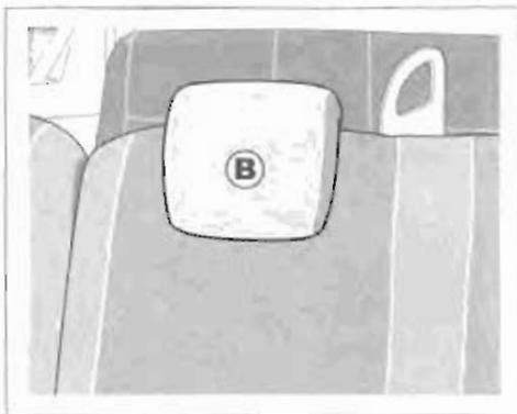
**Рабочее положение подголовника В.** Поднимите подголовник до положения блокировки, чтобы использовать его в верхнем положении. Одновременно нажмите на фиксаторы **3** и **4** и полностью опустите подголовник.
