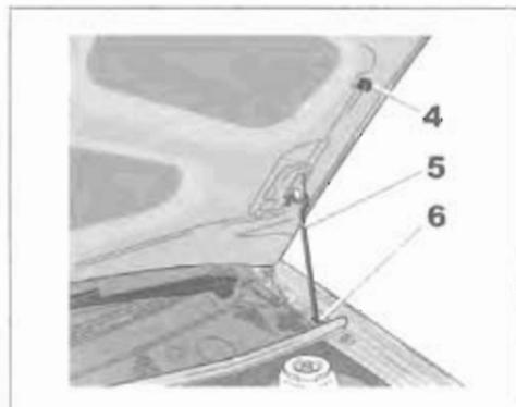
Поднимите крышку капота, освободите упор **5** из фиксатора **4** и, что очень важно для обеспечения Вашей безопасности, **обязательно** вставьте его в гнездо **6** левого крыла.
