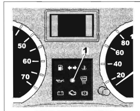
При включении зажигания сигнальная лампа **1** горит, не мигая, в течение приблизительно трех секунд, затем гаснет. Автомобиль распознал код. Вы можете запустить двигатель.
