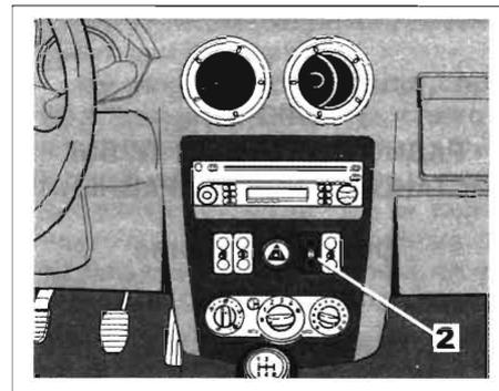
Заблокируйте или разблокируйте замки дверей, нажав на выключатель **2**. Эта кнопка позволяет одновременно запирать и отпирать замки четырех боковых дверей и задней двери.
