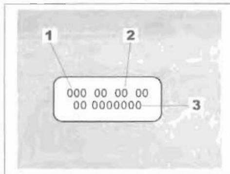
Данные с таблички **C** на двигателе следует указывать во всех запросах и заказах (расположение таблички зависит от установленного двигателя).
