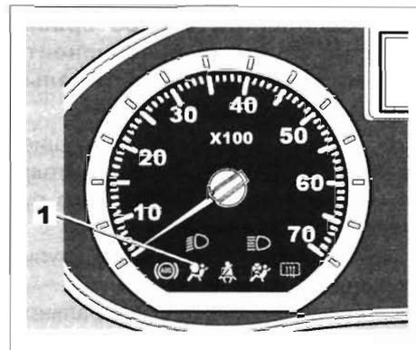
При включении зажигания на несколько секунд загорается сигнальная лампа **1**, расположенная на щитке приборов. Если при включении зажигания сигнальная лампа не загорается или загорается при работающем двигателе, это свидетельствует о неисправности в системе подушки безопасности. В этом случае установка детского сиденья на сиденье переднего пассажира **ЗАПРЕЩЕНА**.
