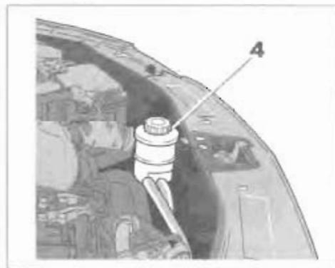
**Уровень:** правильный уровень в **холодном состоянии** на горизонтальной площадке при остановленном двигателе должен быть виден между метками «MIN» и «MAX» на бачках **4** или **5**.
