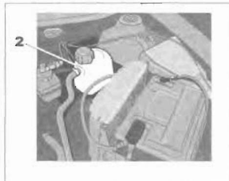
На остановленном на горизонтальной площадке автомобиле с выключенным двигателем уровень **на холодном двигателе** должен находиться между метками «MIN» и «MAX» расширительного бачка **2**.
