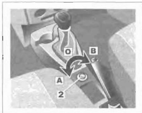
Включив зажигание, поверните переключатель **2**:
