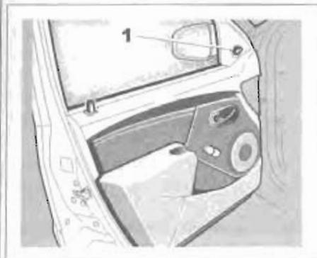
Регулировка зеркала производится с помощью рычага **1**.
