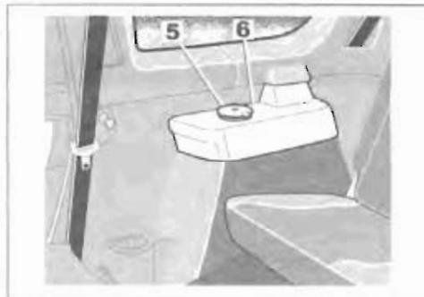
Может устанавливаться в одно из отделений **2, 3, 4** или **6**. Чтобы открыть пепельницу, поднимите крышку **5**. Чтобы очистить пепельницу, выньте ее и вытряхните. Если на Вашем автомобиле не установлены прикуриватель и пепельница, Вы можете приобрести их у дилера компании-производителя.
