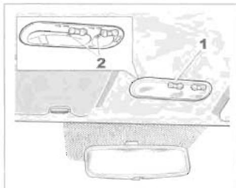
С помощью отвертки с плоским лезвием отсоедините рассеиватель **1**. Извлеките перегоревшую лампу.
