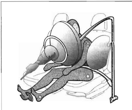
Если зажигание включено, при сильном фронтальном ударе, в зависимости от силы удара, система может задействовать один поршень, который мгновенно отводит замок ремня безопасности назад.
