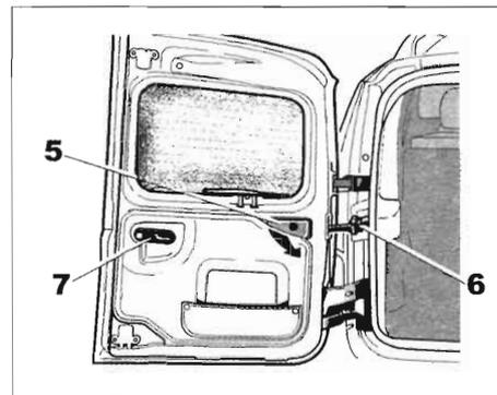
Чтобы полностью открыть дверь, разблокируйте фиксатор, потянув за ручку предохранителя **5**, затем откройте дверь так, чтобы можно было освободить фиксатор **6**. Аналогично откройте другую дверь.
