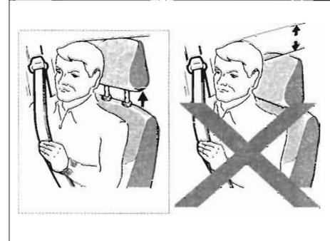
Вставьте стержни подголовника в отверстия направляющих втулок так, чтобы пазы на стержнях были обращены в сторону передней части автомобиля, и установите подголовник на нужную высоту.
