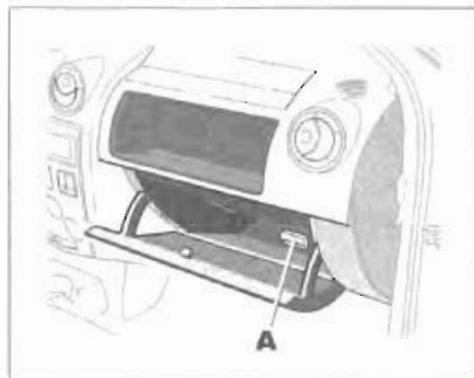
Заглушка **A** на задней стенке вещевого ящика закрывает розетку, предназначенную исключительно для работ, осуществляемых специалистами компании-производителя.
