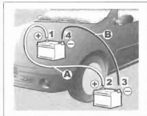
Запустите двигатель автомобиля, от которого выполняется заряд, и оставьте его работать при средней частоте вращения коленчатого вала двигателя.
