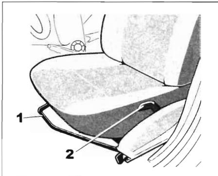
Поднимите ручку **1**, чтобы разблокировать сиденье. Установив сиденье в нужное положение, отпустите рычаг и проверьте надежность фиксации сиденья.
