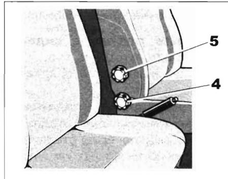
В зависимости от комплектации автомобиля, при включенном зажигании нажмите на выключатель. Система, стабилизирующая температуру, определяет, необходим подогрев или нет.
