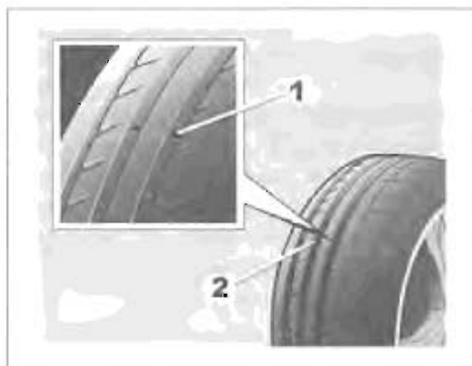
Шины должны быть в исправном состоянии, а протектор должен иметь достаточную глубину рисунка; шины, рекомендованные техническими отделами компании-производителя, имеют специальные выступы-индикаторы износа **1**, которые **отформованы на беговой дорожке колеса**.
