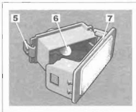
Нажмите на фиксатор 5, чтобы отсоединить рассеиватель 7 и получить доступ к лампе 6.
