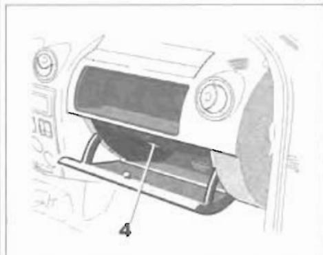
Отсоедините фонарь 4 с помощью отвертки с плоским лезвием, надавив на фиксатор и потянув фонарь внутрь ящика. Отсоедините плафон.
