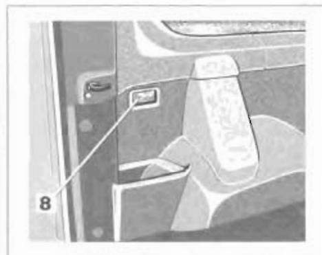
Отсоедините фонарь 8 с помощью отвертки с плоским лезвием, надавив на фиксатор и потянув фонарь на себя.
