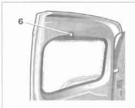
Отверните винт **6** с помощью ключа типа «Торкс» № T30 и извлеките фонарь **7** из его гнезда.
