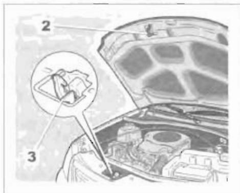
Для разблокировки замка слегка приподнимите капот и освободите крюк **2**, надавив влево на пластинку **3**.
