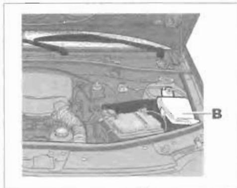
Некоторые системы защищены предохранителями, находящимися в моторном отсеке в блоке **B**. Тем не менее, ввиду затрудненного доступа **рекомендуем Вам обращаться для замены этих предохранителей на сервисную станцию компании-производителя.**
