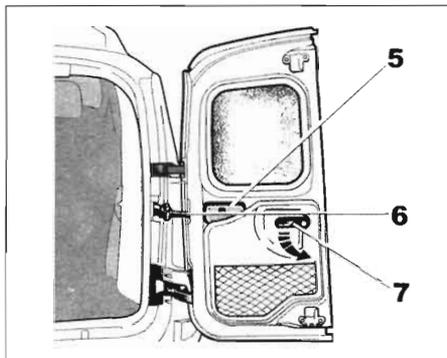
Сначала закройте меньшую из дверей, затем – большую. При этом фиксаторы **6** займут исходное положение.
