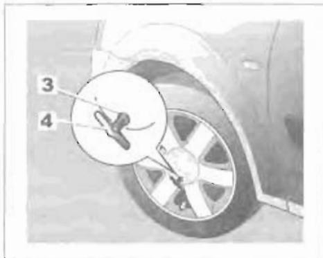
Снимите его с помощью ключа для снятия декоративного колпака, вставив ключ **4** в выемку **3**. Для установки на место сориентируйте выемку **3** по отношению к колесному диску, защелкните и установите болт при помощи ключа **4**.
