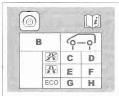
**B:** размеры шин, установленных на автомобиле.
