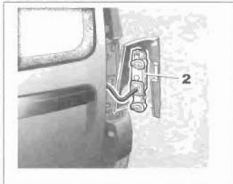
Снаружи снимите фонарь, потянув его назад. Отсоедините разъем жгута проводов от контактной части фонаря. Осторожно снимите контактную часть **2**, чтобы получить доступ к лампам.
